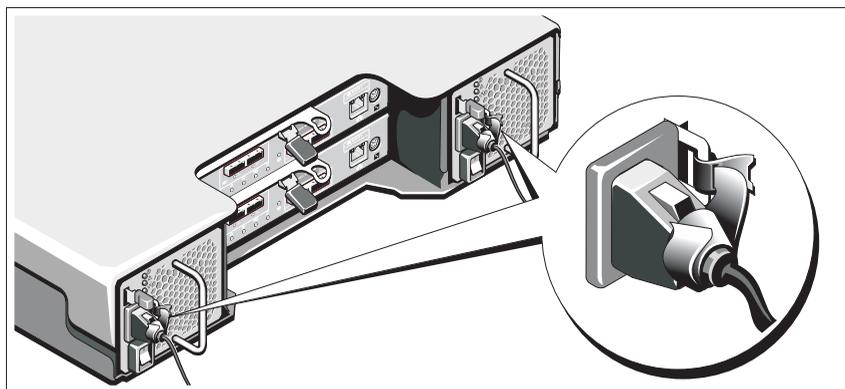
Pomocí řemínku pevně připevněte kabely k držáku.
