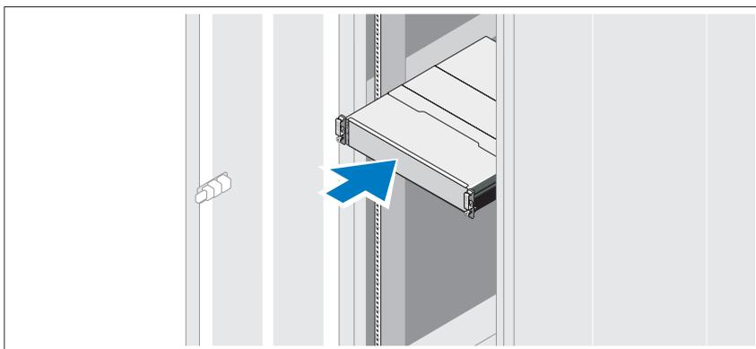
Zamontuj przewodnice i zainstaluj system w stojaku zgodnie z instrukcjami dotyczącymi bezpieczeństwa oraz instrukcjami dotyczącymi montowania systemów w stojaku dostarczonymi wraz z systemem.
