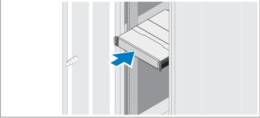
Rayların ve sistemin rafa montajını sistemle birlikte sağlanan güvenlik yönergelerini ve raf montaj yönergelerini izleyerek gerçekleştirin.
